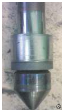
1) Persta HD 2000 højtryksventil med EagleBurgmann 9650/70 pakning efter varmetest ved 650 °C.
